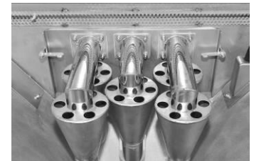
Zyklon-Anlage Cyclone installation Séparation cyclonique
