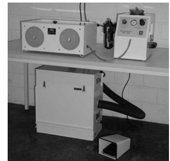
FG 1 Restauo Arbeitsplatz mit Arbeitskabin und Entstauber FG 1 Restauo work station with work cabin and dust absorber FG 1 Restauo lieu de travail avec cabine de travail et dépoussiéreur
